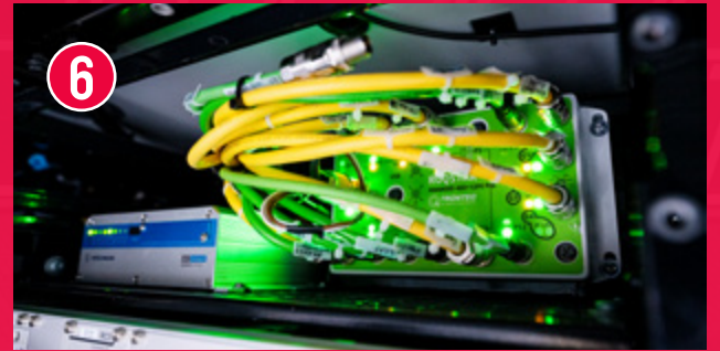
Ein Router (weiß-blauer Kasten) bringt WLAN in den Bus. Das Informations-Netzwerk (rechts) sorgt für Haltestellenanzeigen und andere Fahrgastinfos.
