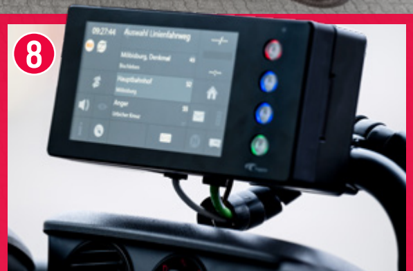
Über das IPT-Terminal erhalten die Fahrer Routen- und Fahrzeitinformationen. Gleichzeitig wird eine Verbindung zur EVAG-Leitstelle hergestellt.
