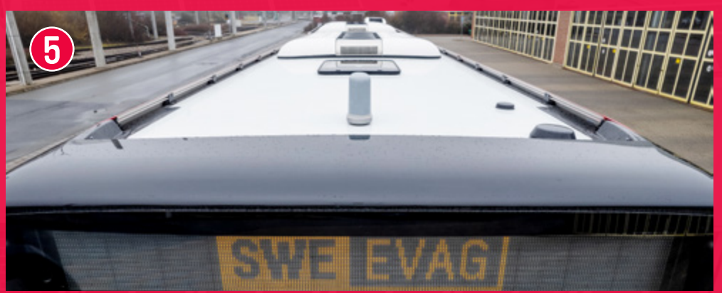
Auf dem Dach steckt jede Menge Kommunikationstechnik, z.B. sitzt hier eine Mobilfunkantenne für das Fahrgast-WLAN.
