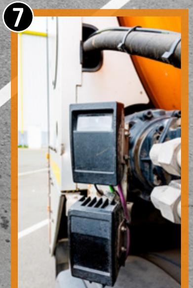
Dank hochmoderner PMD-Technologie werden Objekte und Personen hinter und neben dem Fahrzeug via Lichtimpulsen erfasst. Das System schützt Personen auch in Kurven sowie Ein- und Ausfahrten.
